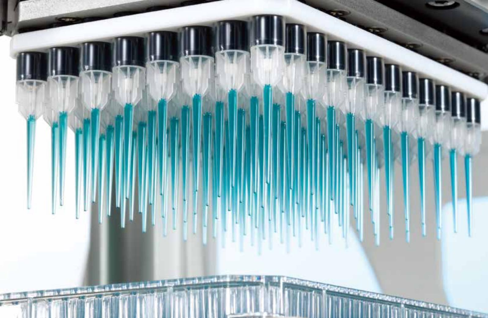
20  $\mu\text{L}$  モデルのリクイデーター 96 は 0.5  $\mu\text{L}$  まで正確にピペッティング
