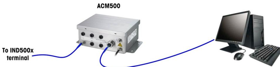
Figura 130: Collegamento con cavo incrociato
