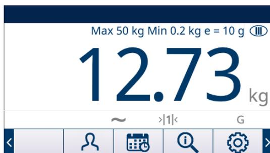
Se l'approvazione è configurata come Argentina e l'interruttore Metrologia, SW1-1, è impostato su ON, è vietato modificare le aree metrologicamente significative nella struttura del menu. Se viene effettuato un tentativo di modifica di un parametro metrologicamente significativo, sullo schermo viene visualizzato il messaggio "Accesso definito. La bilancia è approvata."
