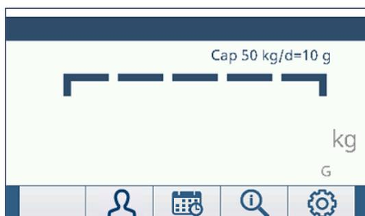
Figura 55: Linee tratteggiate di sovraccarico
