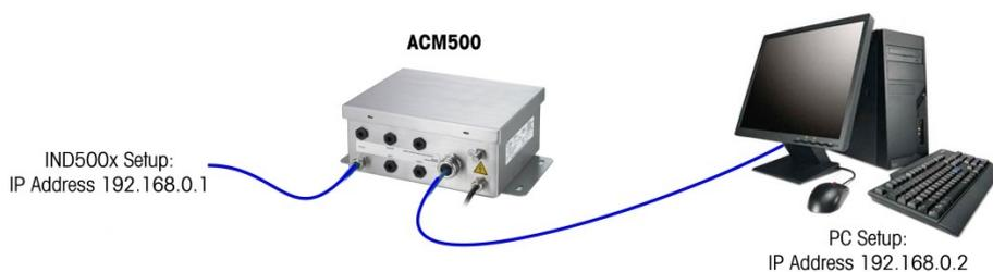
Figura 132: Esempio: Configurazione degli indirizzi IP (configurazione con cavo incrociato o hub)
