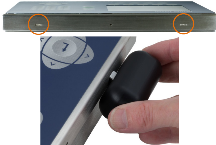
Figura 2-2: Apertura de la caja para ambientes adversos, método preferido
