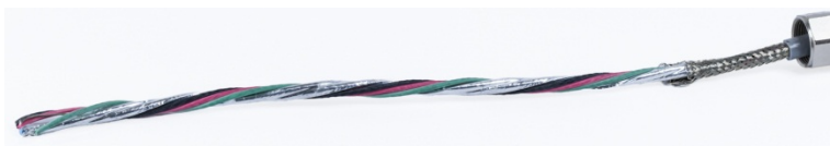
Figure 2-58 : Découpe de la gaine intérieure
