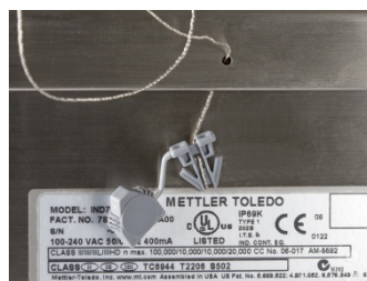
Figura 2-121: Fio de lacre passado por tampa e presilha
