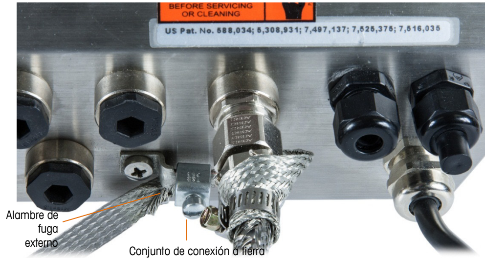
Figura 2-65: Conjunto de cable y cinta instalado en caja para ambientes adversos
