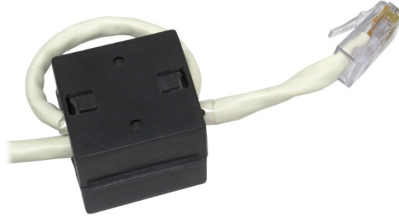
Figure 2-20 : Installation d'une ferrite de type collier
