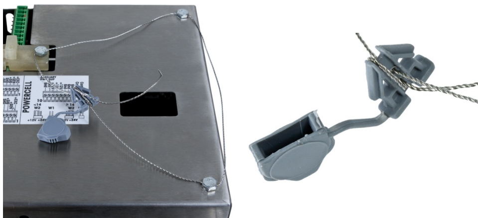
Figure 2-117 : Le fil de plombage étant installé, enfiler le fil à travers le plombage
