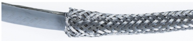
Abbildung 2-55: Äußerer Kabelmantel, über abgeklebtes Ende geschoben
