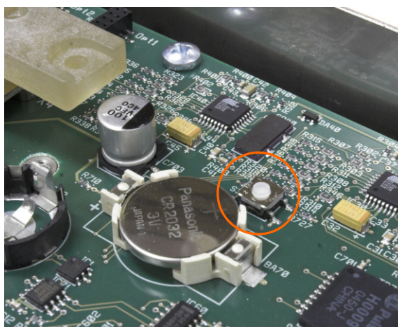
Figura 2-38: Posizione del pulsante di reimpostazione generale sulla scheda madre
