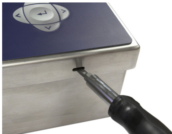
Figura 2-4: Abertura do Gabinete para ambiente adverso, Método alternativo
