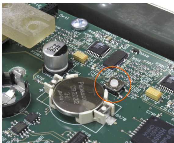
Figure 2-38 : Emplacement du bouton de réinitialisation globale de la carte PCB principale
