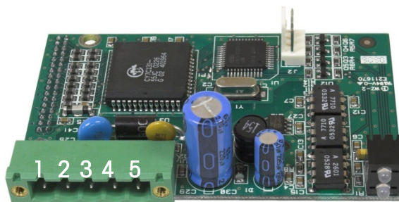
Figure 2-103 : Carte d'option DeviceNet numérotage des broches
