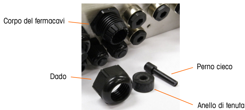
Figura 2-25: Componenti pressacavi
