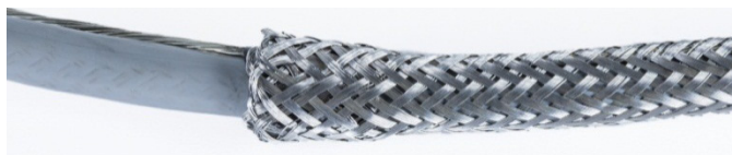
Figura 2-55: Revestimento externo puxado para cima sobre a ponta com fita
