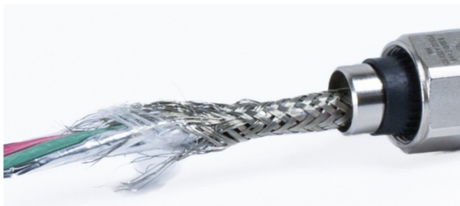
Figura 2-59: Forro interno deshilachado
