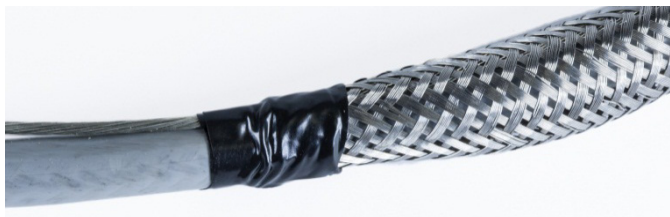
Figura 2-54: Forro externo inmovilizado con cinta eléctrica
